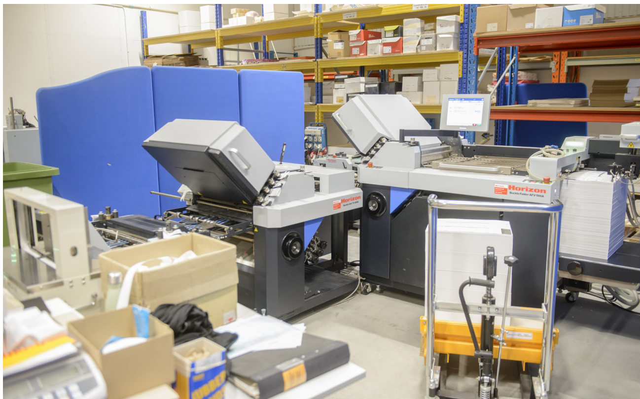
Det skånska tryckeriet har många efterbehandlingsmaskiner från Horizon som denna buckle folder AFV-566A.
